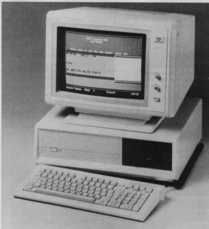
Formschön und leistungsfähig: Multitechs Computermodell MPF-PC/522C, das mit Concurrent-CP/M-86 ausgestattet ist
