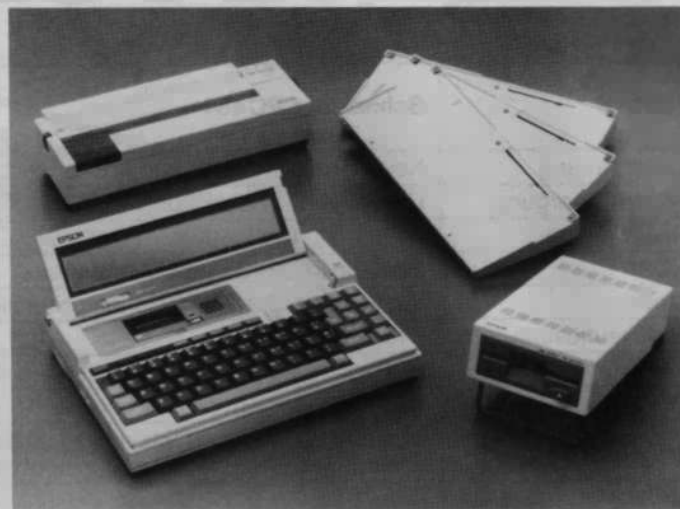
Bild 2. Auch für Epsons PX-8 gibt es jetzt ein 3,5-Zoll-Floppy-Laufwerk
