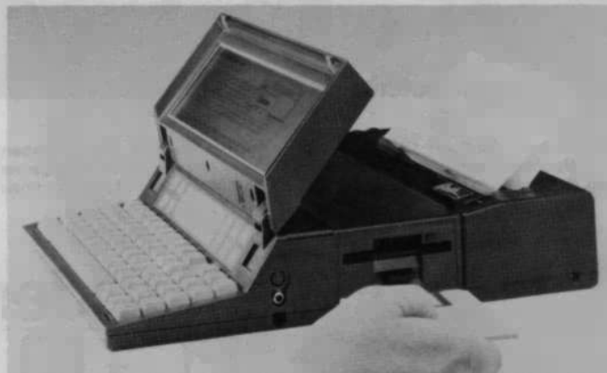
Bild 1. Der „Gavilan“ läuft unter MS-DOS mit 3,5-Zoll-Mikrodiskette
