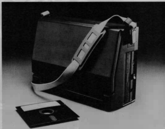
16 Zeilen zu je 80 Zeichen stellt der tragbare Computer Vadem auf seiner Flüssigkristallanzeige dar
