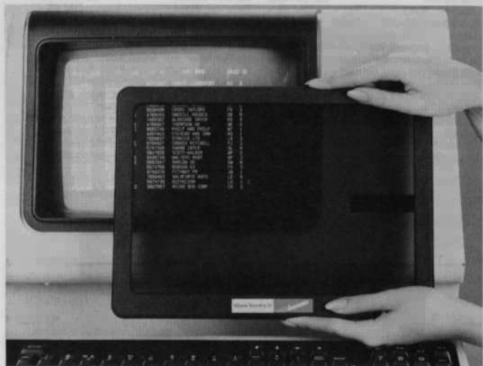
Glare-Sentry als raumfahrterprobter Reflexionsschutz
