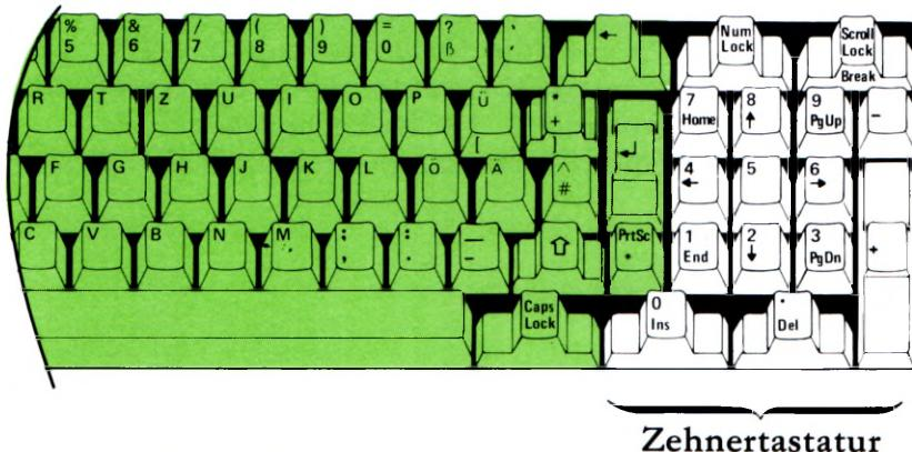
Normalerweise benutzt man die Zehnertastatur mit ihren Funktionen in Verbindung mit dem Korrekturprogramm. Diese Tasten ermöglichen es, den Positionsanzeiger nach oben, nach unten, nach rechts und nach links zu bewegen. Mit Hilfe dieser Tasten ist es möglich, Zeichen einzufügen und zu löschen. Eine vollständige Information findet man im folgenden Abschnitt "BASIC-Korrekturprogramm".
