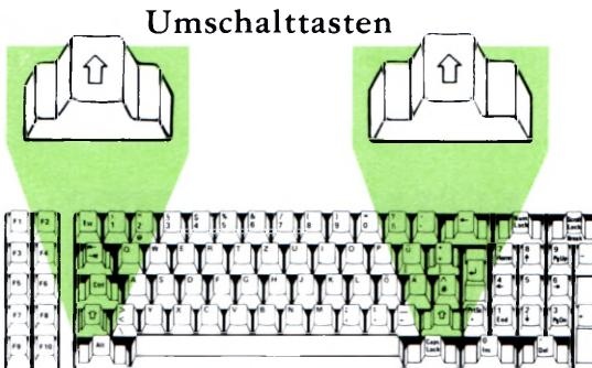
Großbuchstaben und die Sonderzeichen über den Zahlen der numerischen Tasten werden angezeigt, indem man die Umschalttasten betätigt und niederhält und die gewünschte Taste betätigt.
