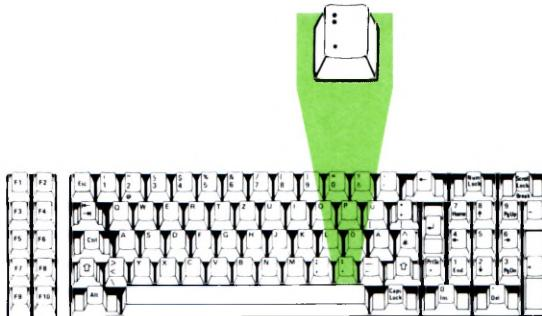
Die Tastatur enthält einige Sonderzeichen, die auf einer normalen Schreibmaschine nicht zu finden sind, wie z.B. ^, [, und ]. Einige Zeichen stehen an einem anderen Platz als man sie auf einer normalen Schreibmaschine erwartet. So erhält man z.B., wenn man die Umschalttaste zusammen mit der Punkttaaste (.) drückt, keinen Punkt, sondern einen Doppelpunkt (:).
